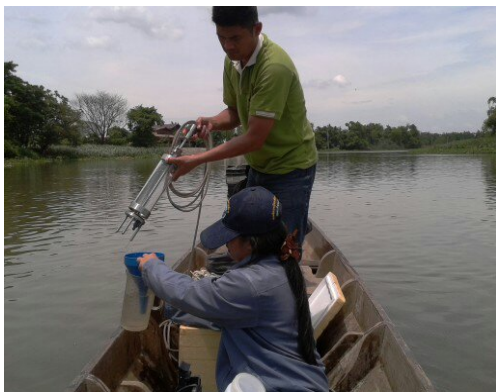
รูปที่ 3.4 การเก็บตัวอย่างน้ำและทดสอบคุณภาพน้ำภาคสนามในคลองบางภาษี (22 มิถุนายน 2555)
