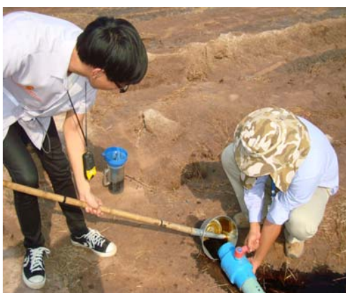
รูปที่ 3.5 การทดสอบคุณภาพน้ำภาคสนาม บริเวณจุดที่มีการปล่อยน้ำทิ้งโรงงานออกสู่สิ่งแวดล้อม
