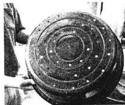
ได้กะละมังต้องเจาะรูแบบนี้ ยกเว้นใบสุดท้ายล่างสุดไม่ต้องเจาะ
